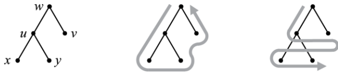
Abb. 6.28: Ein zu durchlaufender Baum (links), durchlaufen mit Tiefensuche (Mitte) und mit Breitensuche (rechts)
