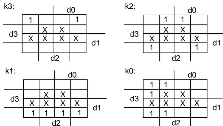
Aus den KV-Diagrammen erhält man durch Zusammenfassung der Kernimplikanten:
