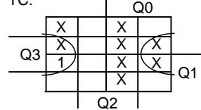
$$Q3^+ = (Q2 \wedge \overline{Q1}) \vee (Q3 \wedge Q2)$$
