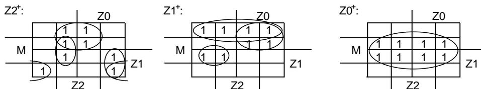
$$Z2^+ = (Z2 \wedge \overline{Z1}) \vee (M \wedge Z2 \wedge \overline{Z0}) \vee (\overline{Z2} \wedge Z1 \wedge Z0) \vee (\overline{M} \wedge \overline{Z2} \wedge Z1)$$
