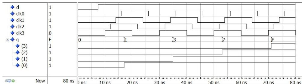
Taktverzögerung positiv: Das Schieberegisterverhalten ist fehlerhaft weil das Ergebnis 0xF schon mit der ersten Taktflanke erreicht wird. Grund dafür ist die Tatsache, dass das jeweils folgende Flipflop sein Taktsignal erst erhält, nachdem der Ausgang des davor befindlichen Flipflops seinen Wert bereits geändert hat. Die Flipflopkette wirkt damit quasi transparent.
