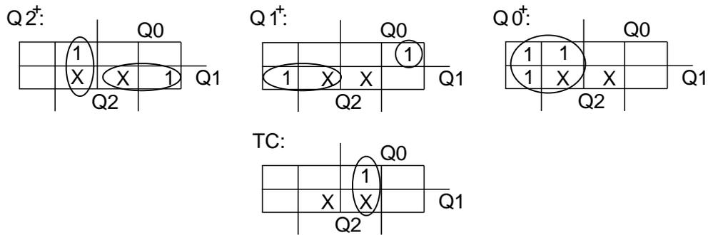
$$Q2^+ = (Q2 \wedge \overline{Q0}) \vee (Q1 \wedge Q0); \quad Q1^+ = (Q1 \wedge \overline{Q0}) \vee (\overline{Q2} \wedge \overline{Q1} \wedge Q0); \quad Q0^+ = \overline{Q0}$$
