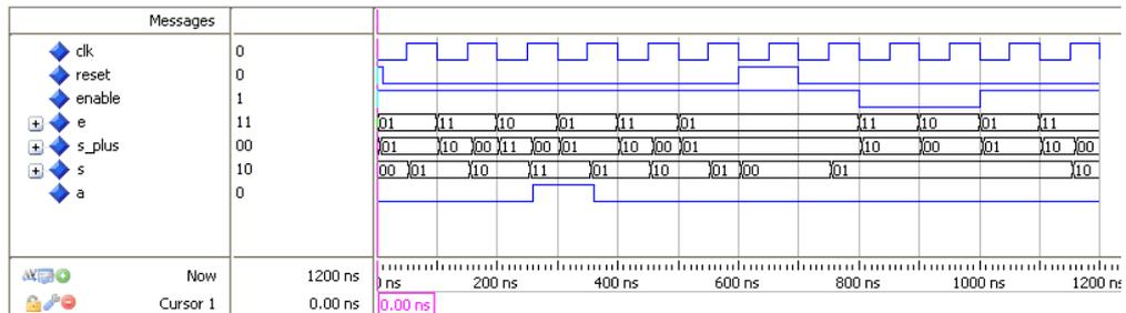
Im Unterschied zu Bild 12.13 wird für den Zustand und den Folgezustand kein symbolischer Zustandstyp verwendet, sondern ein 2-Bit Zustandstyp gemäß der oben gewählten Zustandskodierung. Ansonsten ist das Simulationsergebnis identisch mit dem aus Bild 12.13.
