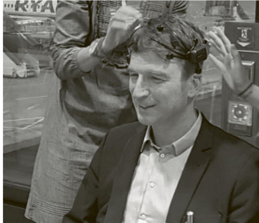
Abb. 25: Einfache Headset-Lösungen zur EEG-Messung (Quelle: http://www.neurosky.com ); eigenes Foto.
