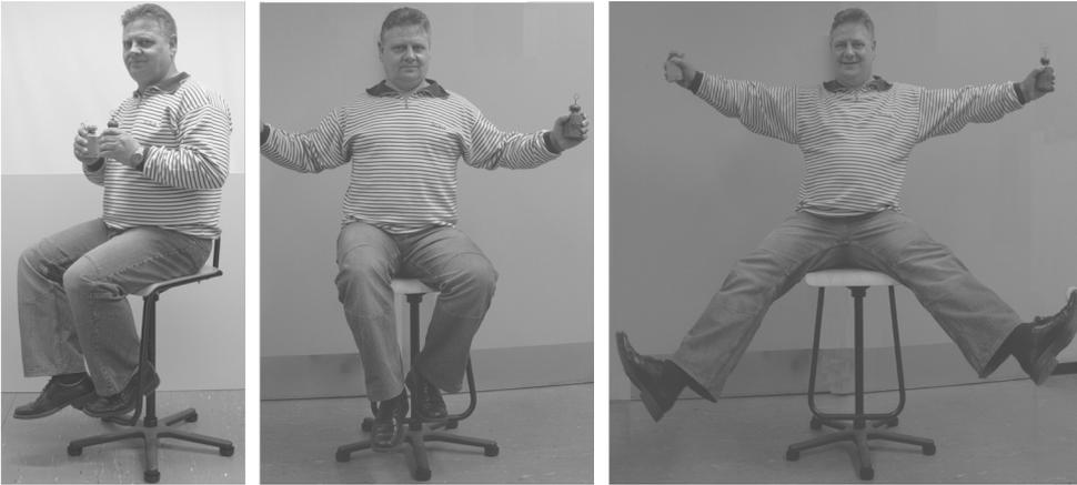
**Abb. 2.90** Änderung des Trägheitsmomentes einer Person, die auf einem Drehstuhl sitzt: Mit wachsendem Trägheitsmoment sinkt die Winkelgeschwindigkeit.
