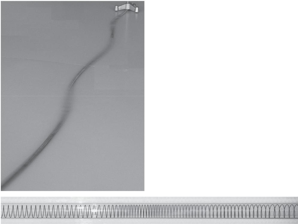
**Abb. 4.46** Transversale und longitudinale Wellen.
