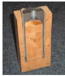
Eingeklebte Rohrstützen für Versuche an dem MPA Wiesbaden, Prof. Leander Bathon.
