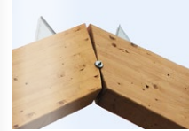
Die GSA-Gelenkverbindung besteht aus zwei Halbschalen, die über einen Konusring und eine Schraube zusammengezogen werden.
