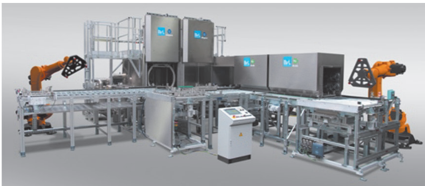
Die BvL-Reinigungsanlagen werden kontinuierlich mit ressourcenschonenden Komponenten wie Isolierung, Abluftmanagement und automatischer Badsteuerung ausgestattet.
