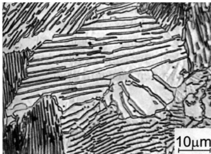
Bild 6: Lamellare Gefügestruktur des Perlits
