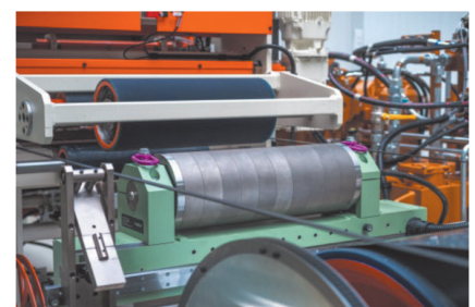
Bild 3: Die zweite (Low-Tension-)Messstation befindet sich im spannungsarmen Auslaufbereich.
