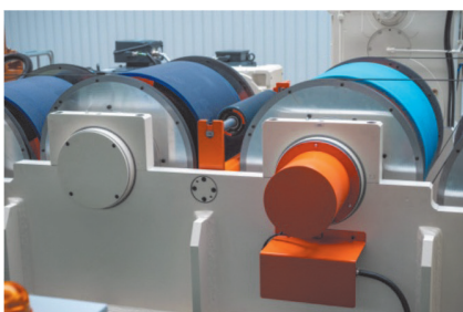
Bild 2: Mit UMS PRO wird die Unplanheit von Bandstahl zweifach gemessen und innerhalb sehr kurzer Zeit korrigiert. Das Bild zeigt die erste, in eine Walze aus Vollmaterial integrierte High-Tension-Messstation kurz nach dem Leveller.
