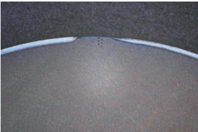
Bild 1: Störung im Aufbau der Nitrierschicht durch Passivierung
