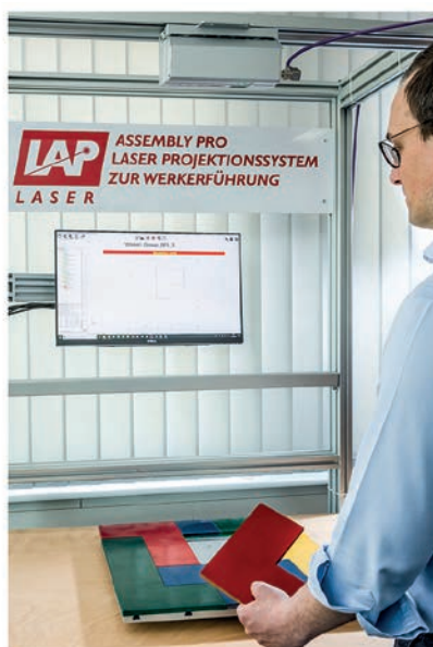
Montagearbeitsplatz mit Laserprojektor
