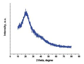
Figure 1. XRD of pure gelatin (Fluka)
