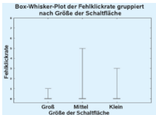
Bild 8: Box-Whisker-Plot der Fehlklickrate gruppiert nach der Größe der Schaltfläche
