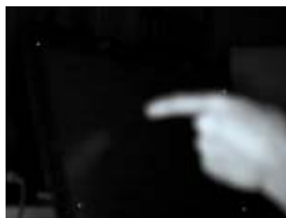
Bild 3: Originale Amplitudendaten einer Hand, welche mit einer ToF-Kamera aufgenommen wurde
