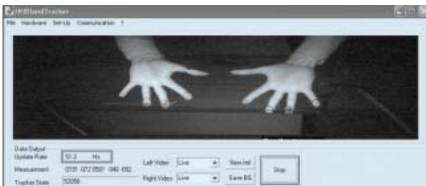
Bild 1: Oberfläche der Tracking-Software mit Bild aus einer Tracker-Kamera. Es wurden zehn Finger erkannt
