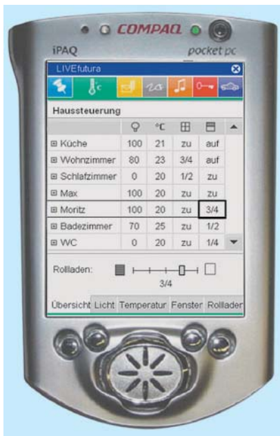
Bild 8: PDA Bedienoberfläche LIVEfutura: effiziente Rolladensteuerung über Tabellenansicht
