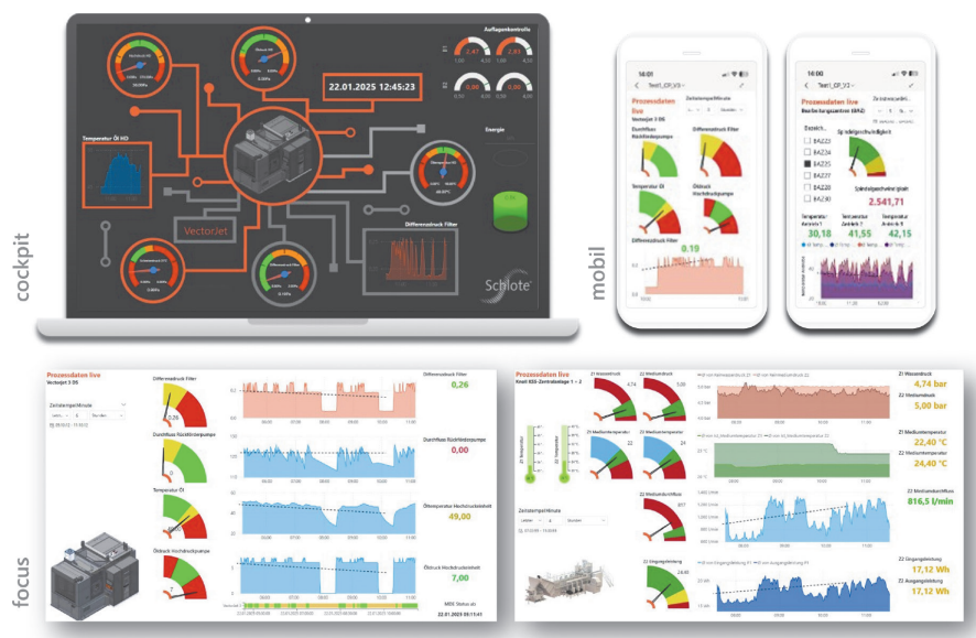
Bild 3. Aktuelle Live-Werte und kurzfristiger Zeitverlauf im zulässigen Grenzwertbereich, der durch die Anwendenden definiert werden kann (Quelle: Schlote Gruppe)
