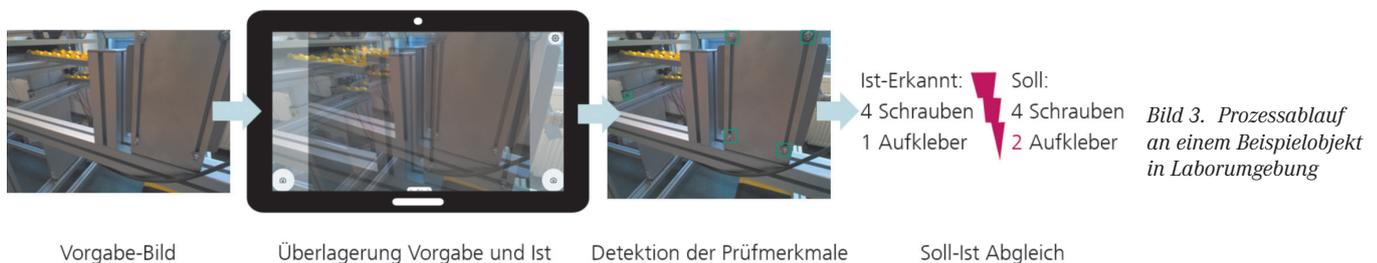
Bild 3. Prozessablauf an einem Beispielobjekt in Laborumgebung
