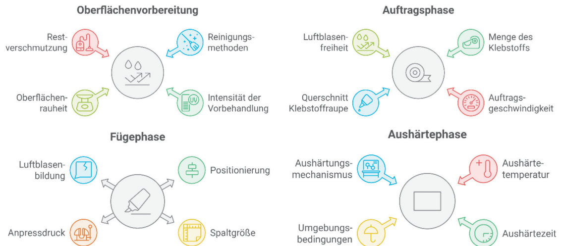
Bild 1. Auswahl wichtiger Prozessschritte und -parameter bei einem Klebprozess
