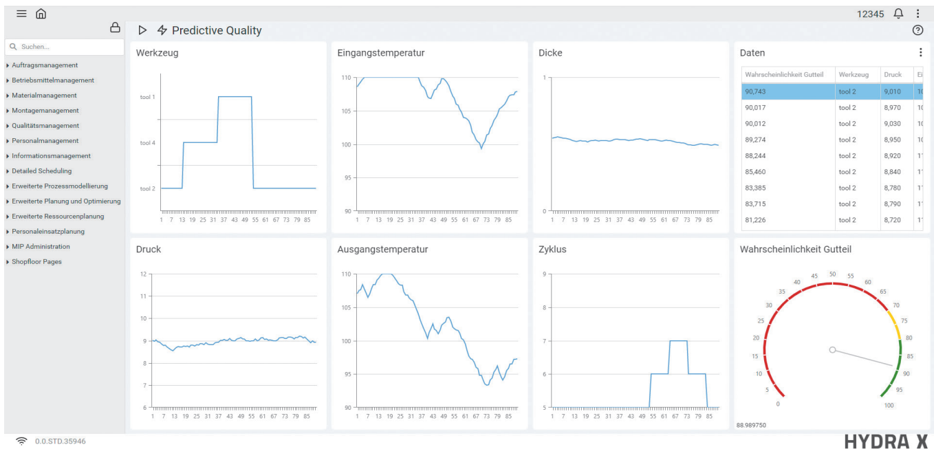
Bild 3. Predictive Quality kann die Qualitätseinstufung eines Produkts vorhersagen, das aktuell produziert wird (Quelle: MPDV)
