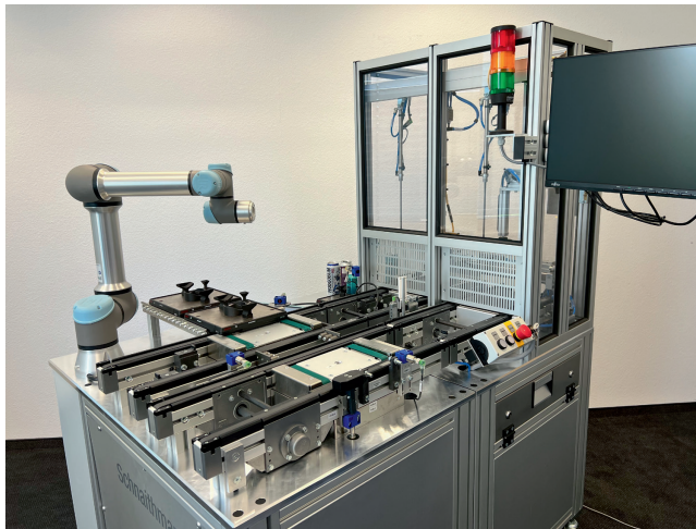
Bild 3. Verkettete automatisierte Demonstratoranlage mit Messstation und Cobot
