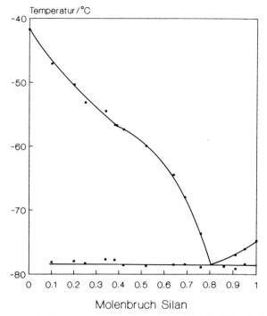
Abb. 2. Phasendiagramm des Systems Pyridin/Trimethylfluorsilan.
