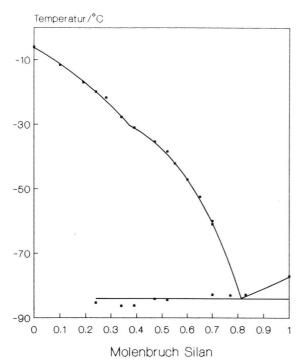
Abb. 6. Phasendiagramm des Systems 2.6-Lutidin/Methyltrichlorsilan.
