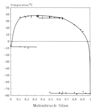
Abb. 7. Phasendiagramm des Systems 3.5-Lutidin/Methyltrichlorsilan.
