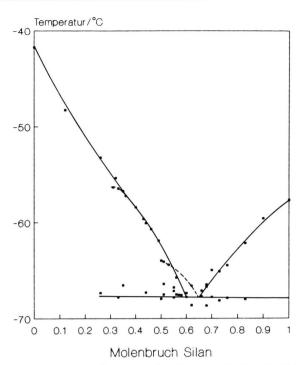
Abb. 4. Phasendiagramm des Systems 2.4-Lutidin/Trimethylfluorsilan.
