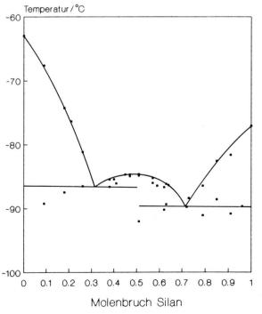
Abb. 3. Phasendiagramm des Systems Pyridin/Trimethylchlorsilan.
