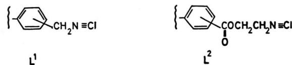
Zur Darstellung von  $\text{L}^2$  wird die Chlormethyl- in eine Aldehydfunktion übergeführt [7]; anschließende Oxydation und Behandlung mit Thionylchlorid ergibt ein Säureanhydrid, das mit der Hydroxygruppe von  $\beta$ -Isocyanoethanol [8, 9] zum Ester ( $\text{L}^2$ ) reagiert:
