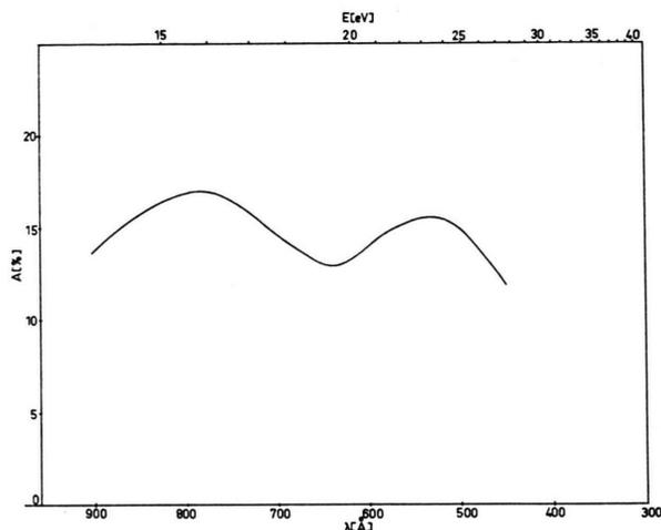
Abb. 2. Photoelektrische Ausbeute der verwendeten Goldkathode.
