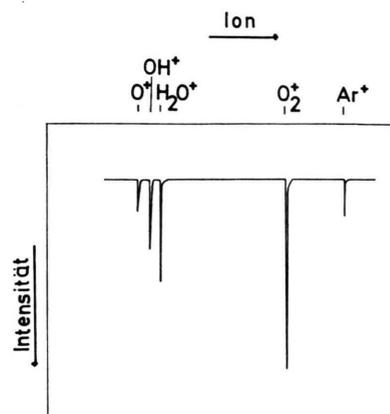
Abb. 3a). Massenspektrum für die eingestrahlte Wellenlänge 610 Å ohne Entladung.  $O^+$  entsteht nur durch dissoziative Ionisation.
