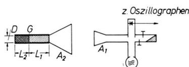
Abb. 1. Schema der Meßanordnung.  $L_2$  Sprengstoffstrecke = 60 mm,  $L_1$  Isoliermaterial = 80 mm,  $D = 10$  mm.  $f_0 = 34,5$  GHz;  $\lambda_0 = 8,69$  mm.
