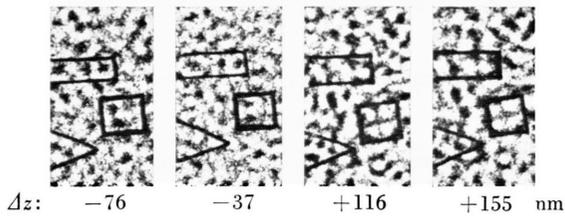
Abb. 3. Kontrastumkehr an Strukturen im Bild einer Kohlefolie bei Änderung der Defokussierung  $\Delta z$ . Die den Kontrast erzeugende Phasenverschiebung beträgt bei den beiden linken Aufnahmen  $\approx +\pi/2$ , bei den beiden rechten Aufnahmen  $\approx -\pi/2$ . Die Abstände der Strukturen in den markierten Gebieten liegen im Bereich 0,7–1,0 nm.
