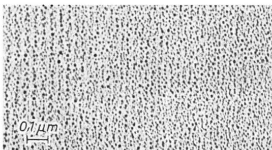
Abb. 2. Elektronenmikroskopische Aufnahme sehr eng benachbarter Schalllinien. Beschallung mit 19 kHz. Kleinster Linienabstand  $\lambda_B \approx 250 \text{ \AA}$ , somit kleinste Bruchgeschwindigkeit  $v_B \approx 0,5 \text{ mm/s}$ . Vergr. = 50 000  $\times$ .
