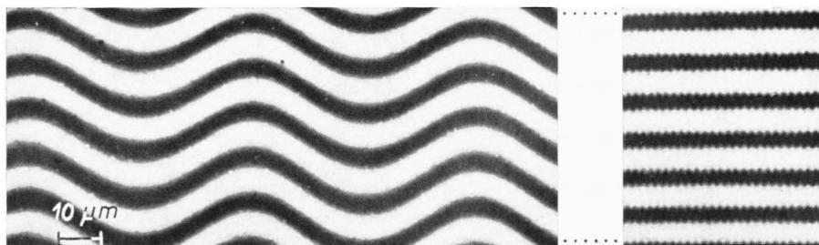
Abb. 3. Interferenzmikroskopische Aufnahmen von mit 1 MHz beschallten Bruchflächen. (Interferenzschritt  $\Delta = 0,3 \text{ \mu m}$ .) Vergr. = 600  $\times$ .
