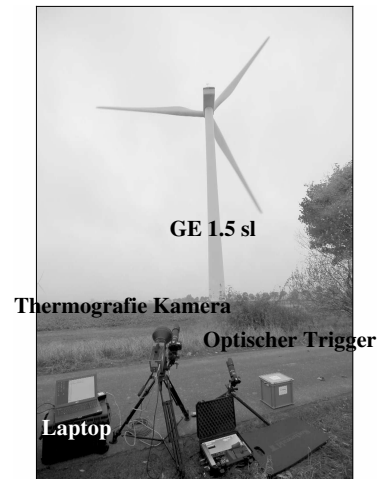
Abb. 4: Versuchsaufbau an der Windenergieanlage mit Thermografiekamera, optischem Trigger und Auswerterechner im Vordergrund und der Windenergieanlage GE 1.5 sl mit einem Abstand von 169\text{ m} im Hintergrund.
