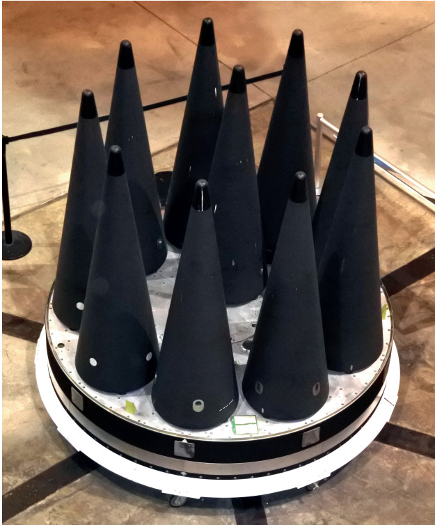
Abb 2: Mehrfachsprengkopf (MIRV) der amerikanischen Interkontinentalrakete LGM-118A Peacekeeper
