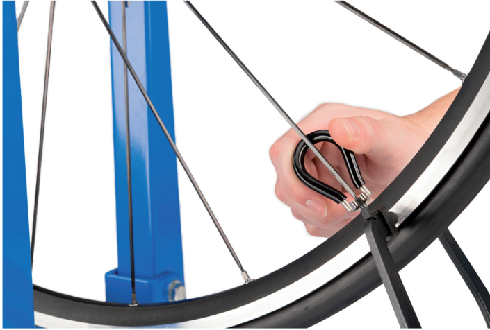
Abb. 6: In Zentrierständer eingespanntes Laufrad mit Felge, Speichen, Speichennippeln und Speichenschlüssel (Parktool 2021).
