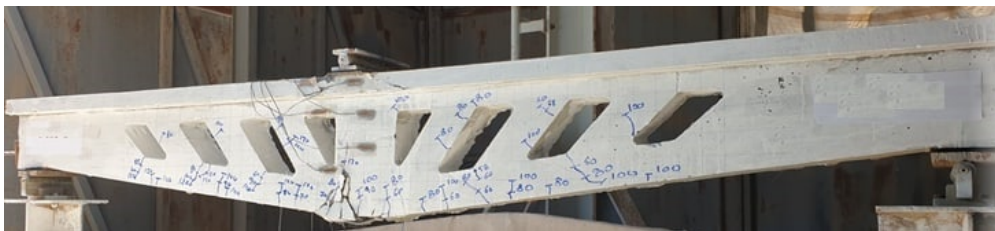
(d) Failure and crack patterns of NPQI8
