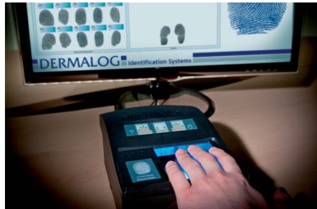
Abb. 3: Mit dem LF10-Scanner von Dermalog wurden die Fingerabdrücke gescannt.
