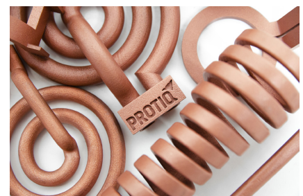
Vielfalt in der Induktorfertigung: Unterschiedliche Geometrien, optimierte Designs und sogar direkt integrierte Logos und Beschriftungen – ermöglicht durch additive Fertigung.
