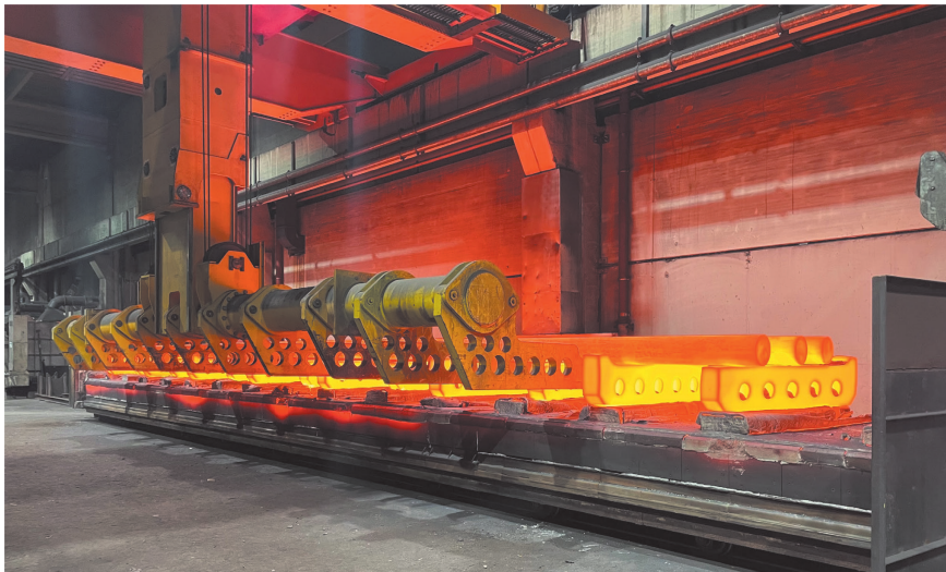
Bild 1: Im Bereich der Wärmebehandlung 3 kann Stabstahl bis zu einer Länge von 18.000 mm vergütet werden.
