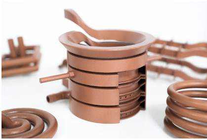
Der speziell entwickelte SLM-Prozess von PROTIQ zur Verarbeitung von hochleitfähigem Reinkupfer eröffnet neue Möglichkeiten für Induktoren-Designs und optimierte Spulenschnittschnitte – hier veranschaulicht in einer Schnittdarstellung.
