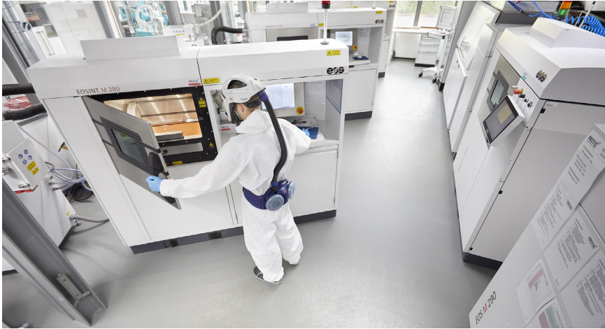
Additive Fertigung auf höchstem Niveau: Die SLM-Technologie ermöglicht die Herstellung hochleitfähiger Kupferbauteile mit komplexen Geometrien.
