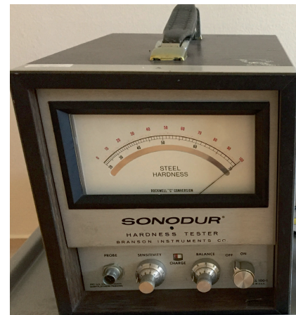
Bild 1: SonoDur 1965, mit Rockwell-Skala. Die Hand-Sonde hatte damals eine Prüfkraft von 0,5 kg (5 N).
