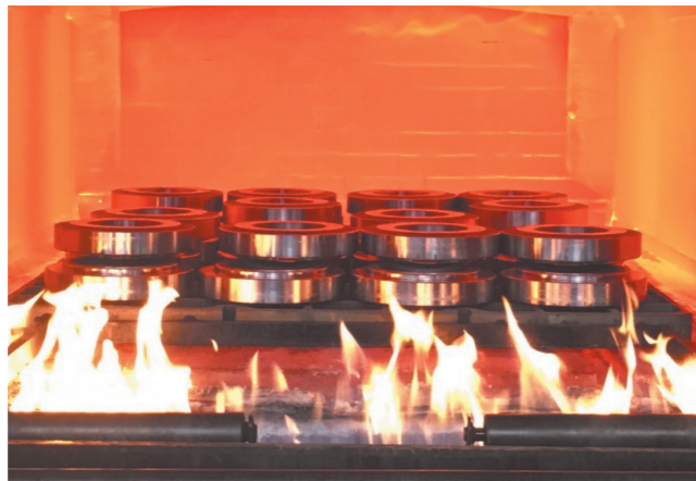
Abbildung 2: Beispiel einer klassischen Charge nach der Beladung einer Schutzgas-Mehrkammerofen-Anlage
