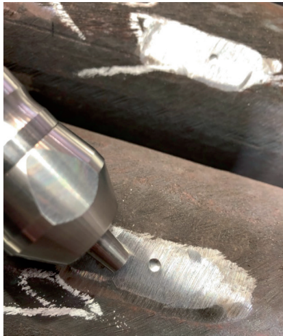
Abb. 1: Brinell-Eindruck auf geschruppter Oberfläche, deformierter Querschnitt. Erschwerte Bedingung für Anwendung portabler Härteprüftechnik mit mikroskopisch feinem Prüfeindruck (Prüfspitze einer UCI-Sonde im Bild).
