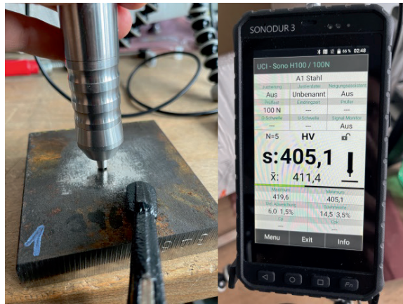
Abb. 5.1 und 5.2: Härtemessung an Stahl-Blech blank geschliffen mit P 120. Der Härtewert von 411 HV vor der Umwertung in 390 HB UCI liegt deutlich über dem Referenzwert von 346 HB. Falls der Unterschied durch den Einfluss des E-Moduls verursacht worden sein sollte, müsste für die Justierung ein Wert CAL = 2000 gewählt werden, was einer Anpassung an Gusseisen entsprechen würde. Dies ist unwahrscheinlich.
