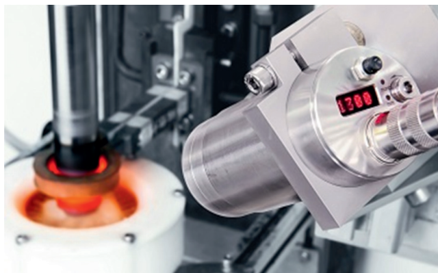
Abb 4: Beispielhafte Darstellung der Temperaturüberwachung eines Induktionsprozesses mittels IGAR 6 Smart im Quotientenmodus
