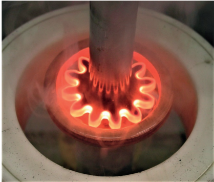
Abb 1: Induktionshärteprozess eines Zahnrads
