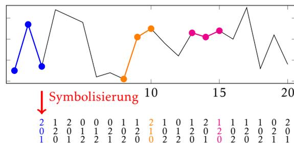
Abbildung 2. Bestimmung von ordinalen Mustern der Länge  $d = 3$  und der Verzögerung  $\tau = 1$  zu jedem Zeitpunkt  $t = d, d + 1, \dots, 19, 20$
