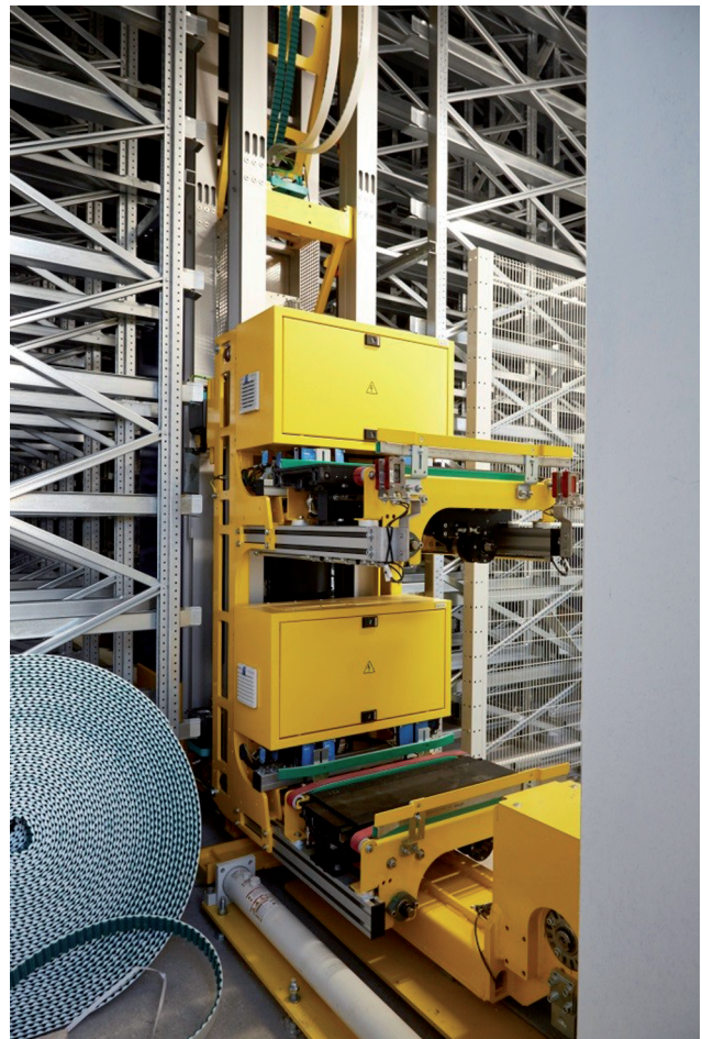
Abb. 3: Das Regalbediengerät mit den übereinanderliegenden Lastaufnahmemitteln (Foto: U. Niederer)
