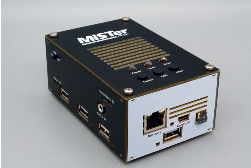
Abb. 16: In der voll ausgebauten Variante mit drei Platinen übereinander und im offiziellen MiSTer-Gehäuse ist der FPGA nicht viel größer als eine Raspberry Pi.
