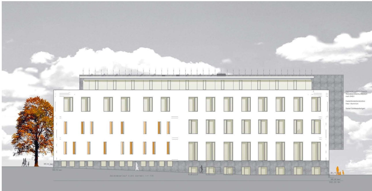
Abb. 5: Luitpoldhaus, Ansicht Ost mit Freihandbereichen und der weitgehend fensterlosen Fassade zu Lesesaal und Magazin für schriftliches Kulturgut im ersten und zweiten Obergeschoss (Grafik: Baum-Kappler Architekten GmbH, Nürnberg)
