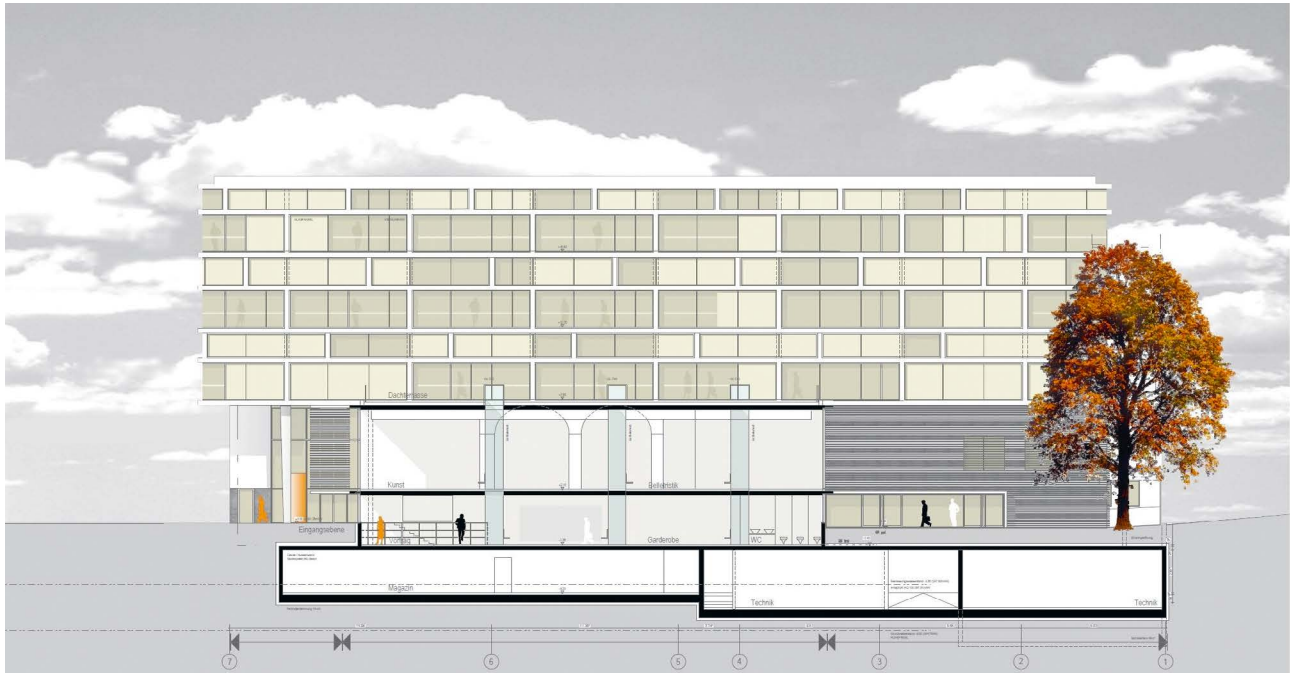
Abb. 4: Luitpoldhaus, Ansicht West mit den Freihandbereichen, angeschnitten das unterirdische Magazin für Altbestände im Verbindungstrakt zum Katharinenkloster (Grafik: Baum-Kappler Architekten GmbH, Nürnberg)
