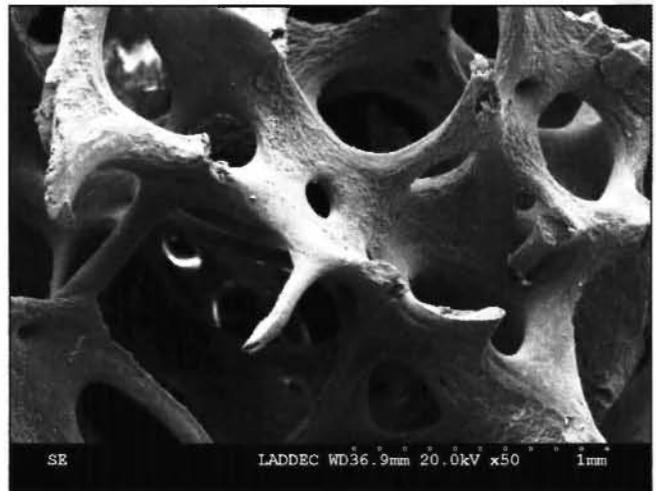
Abb. 6: REM-Aufnahme von gereinigtem, porösem Rinderknochen aus der Schienbeinepiphyse. Handelsprodukt für Knochenimplantate
