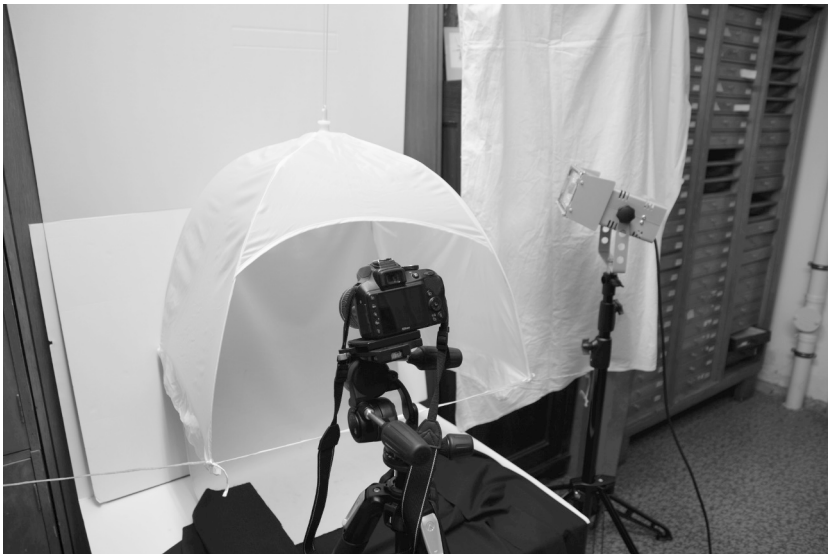
Abbildung 3: Lichtzeltkonstruktion für Fotoaufnahmen. Foto: Jörg Neumann.
