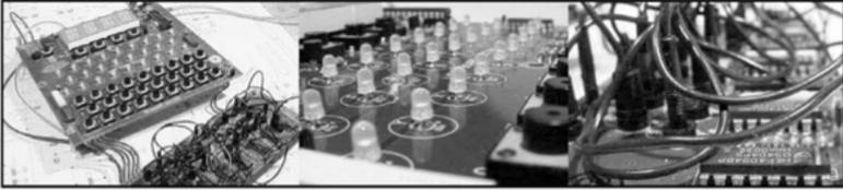
*Die Enigma als Elektronik-Bausatz: Links eine Gesamtansicht. Deutlich erkennbar sind Tastatur und Lampenfeld. Mitte: Als Lampen dienen Leuchtdioden. Rechts: Das Steckerbrett ist mechanisch von den übrigen Elementen abgetrennt.<sup>148</sup> (Reproduktion mit freundlicher Genehmigung der Autoren)*
