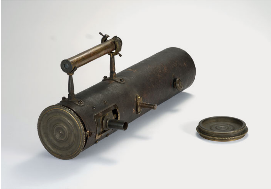
77 Spiegelteleskop nach Isaac Newton , Glas, Metall, Leder, 38,5 × 7,3 cm, Kölnisches Stadtmuseum, Mathematisch-Physikalisches Kabinett, L 266
