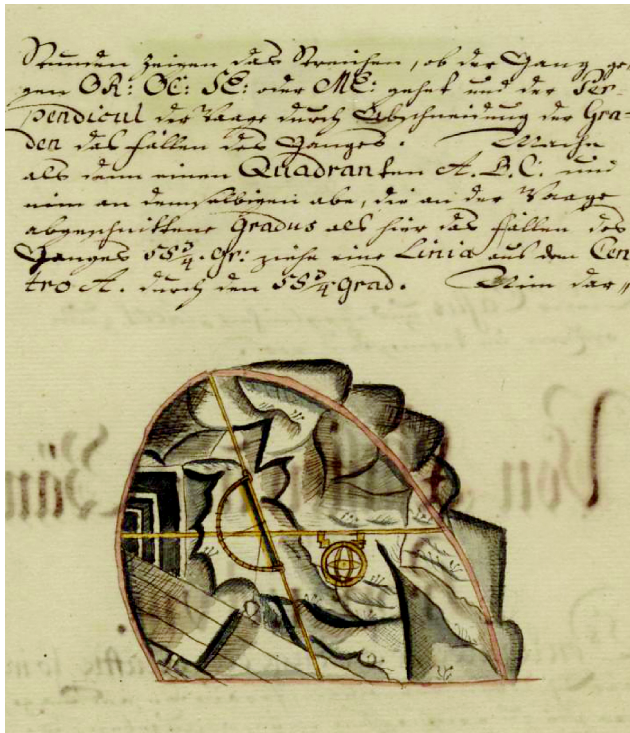
Abb. 4: Darstellung des Vermessungsvorgangs mit dem Gradbogen zur Bestimmung des Neigungswinkels sowie mit dem kardanisch aufgehängten Kompass zur Bestimmung der Richtung. Adam Schneider, Neu-Markscheidebuch, Altenberg, um 1669, fol. 50v, UB TU Bergakademie Freiberg, XVII 18.
