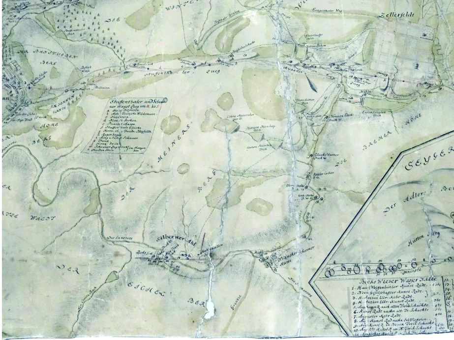
Abb. 14: Ausschnitt aus dem Generalriss. Dargestellt ist das Wasserwirtschaftssystem um die Bergstadt Zellerfeld. Johann Heinrich Eggers, General Charte derer sämtlichen Communion-Oberharzischen Züge, Hütten und Pochwerke nebst denen gesamten dazugehörigen Teichen, Gräben und Wasserfälle, Zellerfelder, 1727, NLA WO, K 3953 (CC BY-NC-ND 4.0).
