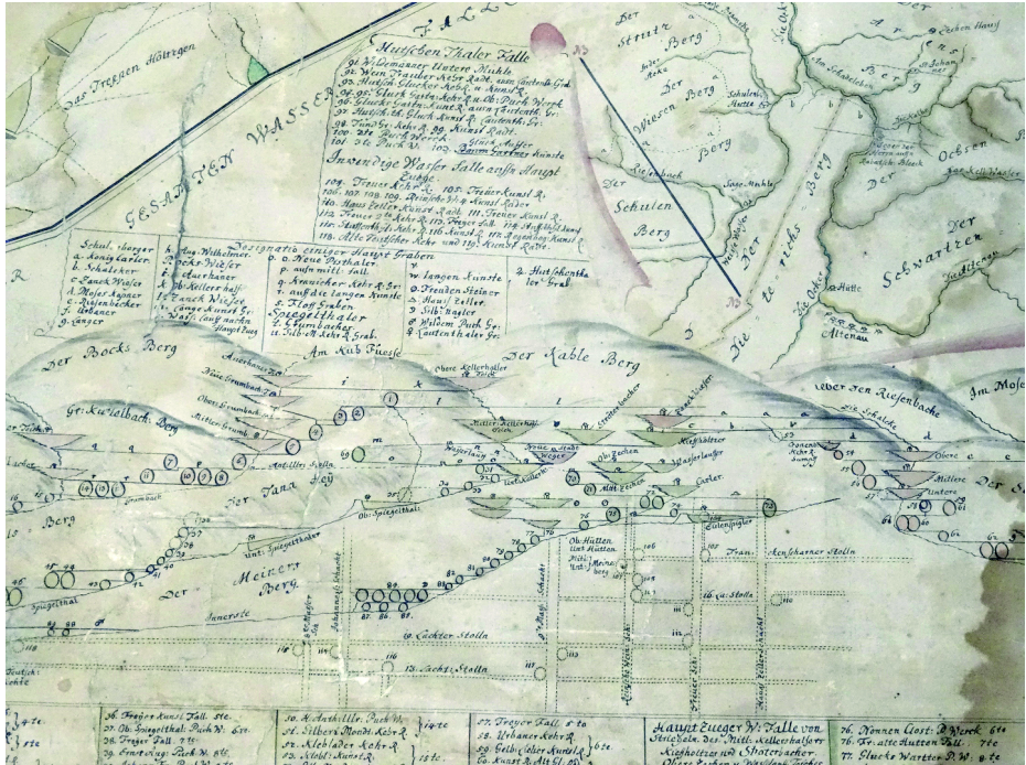
Abb. 15: Ausschnitt aus dem Generalriss. Dargestellt sind die gesamten Wasserfälle des Zellerfelder Reviers im Seigerriss. Johann Heinrich Eggert, General Chartre derer sämtlichen Communion-Oberharzischen Züge, Hütten und Pochwerke nebst denen gesamten dazugehörigen Teichen, Gräben und Wasserfälle, Zellerfelder, 1727, NLA WO, K 3953 (CC BY-NC-ND 4.0).
