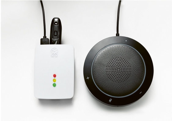
Abb. 16: Conditional Voice Recorder (CRV), bestehend aus Konferenzmikrofon (rechts) sowie Raspberry Pi 3 mit USB-Stick (links); Bild: Sina van Oostrum.
