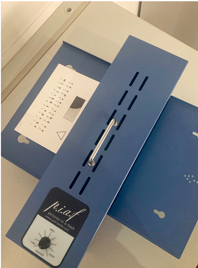
Abb. 1: Ein Schwellkopiergerät mit einer tastbaren Abbildung (Foto: Anna Krause).
