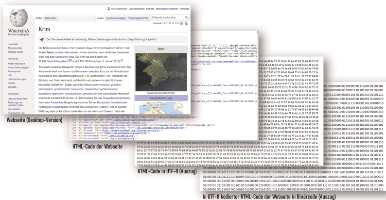
Abb. 1: Die Stufen der Kodierung einer Webseite von ihrer spezifischen Ausgabe für Desktoprechner bis zum Binärcode am Beispiel der Webseite https://de.wikipedia.org/wiki/Krim (Zugriff am 23.03.2022). Abbildung von Torsten Hiltmann.
