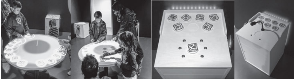
Abbildung 1: (a,b) Der Radar-Tisch mit aufgelegten Steinen. (Fotos: Michael Bode) (c) Ladestation zur Auswahl eines Sounds aus einem Set. (d) Ladestation mit Mikrofon zur Aufnahme eines eigenen Sounds
