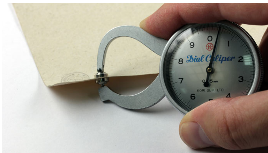
Abb. 4: Mikrometer zur Dickenmessung der Papiermembran am Blattrand
