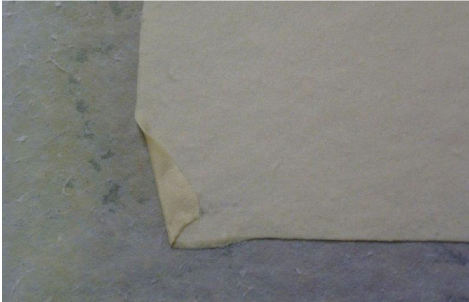
Abb. 11: Gautschfehler Überlappung bei frisch geschöpftem Papier aus der Werkstatt von Johannes Follmer
